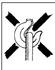
Rys. 2 c Zapadka haka jest zablokowana – zagrożenie utraty ładunku
