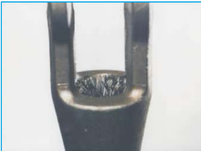
Prawidłowo wyśrodkowana końcówka z drutami kończącymi się równo z górną krawędzią koszyka końcówki (Rys. 3).
