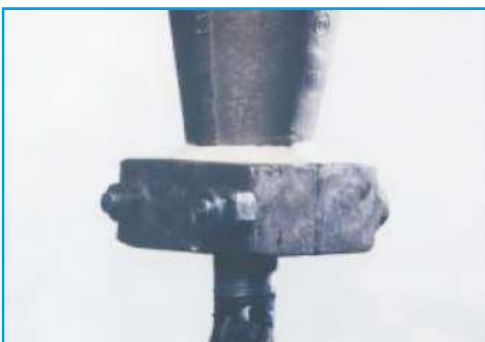
Wykorzystanie uchwytu do wyśrodkowania liny (Rys. 5.).
