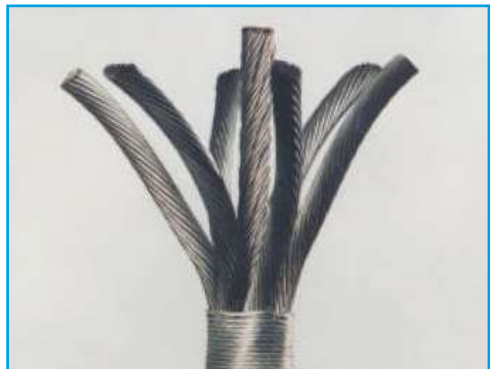
Rozkręcanie i rozginanie liny <60° (Rys.1).
