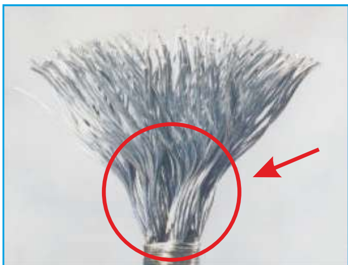
Nieprawidłowo rozkręcona szczotka.
