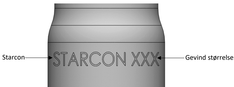
Figur 2 Mærkning på cylinderen på indsatsen til fastgørelse.
