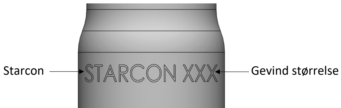
Figur 2 Mærkning på befæstigelsess cylinder til fastgørelse.
