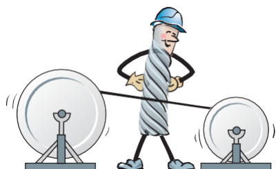
Figura 2-5: no cree una curva inversa nominal de la cuerda
