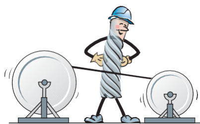
Joonis 2-5 – ärge tekitage vastupidist painet Joonis 2-6 – paigaldage kõis pingul, umbes 10% nimikoormusest
