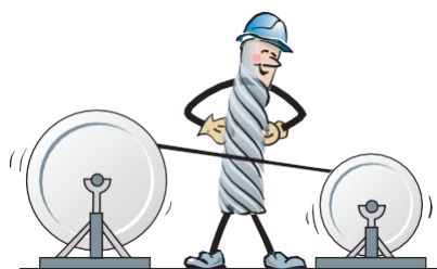
Figure 2-5 - Ne pas créer de courbure inverse traction du câble
