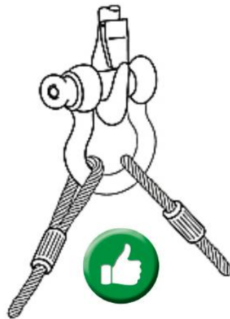
Fig. A.4 Korrekt – brug to reb med øjer
