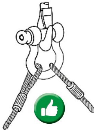
Joonis A.4 Õige – kasutage kahte silmusega köit
